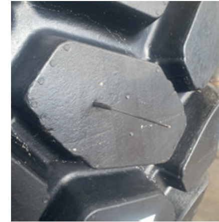
Der entwickelte Reifenabriebsensor lässt sich für Nutzfahrzeuge nachrüsten.
